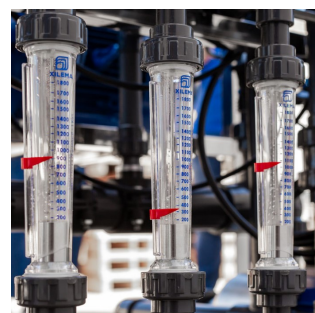
Batería Venturi de caudalímetro tipo rotámetro
